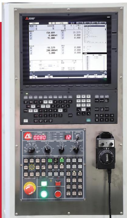
Станки серии VM оснащены современными стойками ЧПУ компаний Siemens, Fanuc и Mitsubishi. Для удобства работы оператора мы оснастили станок 15" LCD экраном, который позволяет улучшить восприятие и избежать различных ошибок из-за маленького экрана.
